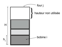
Il y a q bobines à combiner pour faire les m piles qui seront recouvertes par les m fours, q étant suffisamment grand pour qu'on laisse sûrement des bobines pour les cuissons suivantes. Chaque bobine i a une hauteur  $h_i$ .
